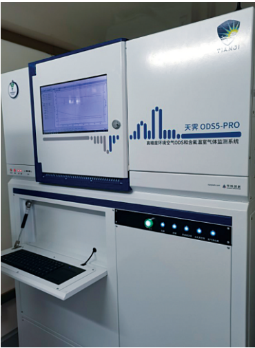
含氟温室气体及消耗臭氧层物质全要素在线观测系统（天霁ODS5-PRO）
