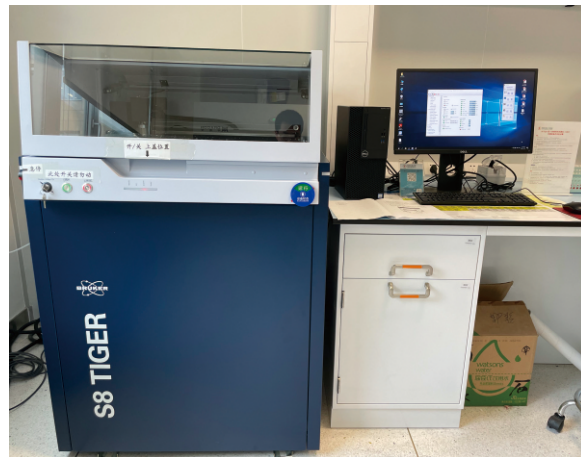
X射线荧光光谱仪 (Bruker S8 Tiger)
