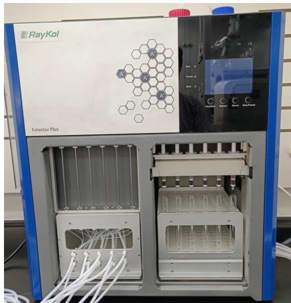
全自动固相萃取仪 (Fotector Plus)
